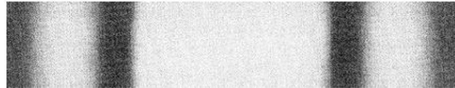
**padrão de franjas claras e escuras resulta da superposição de um grande número de ondas de mesmo comprimento de onda, que foram difratadas pela fenda, em uma dada região do espaço.**
