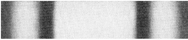
Figura 5: Franjas claras e escuras em um anteparo, devido à difração de luz por uma fenda.
