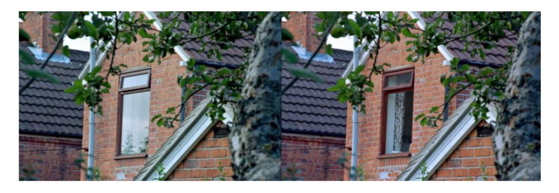
Ângulo Brewster: Fotografia tirada de uma janela com um filtro polarizador a dois ângulos diferentes. Na esquerda, o polarizador está alinhado com o ângulo de polarização da reflexão janela. Na foto à direita, o polarizador foi girado 90° eliminando a luz solar refletida fortemente polarizada.
