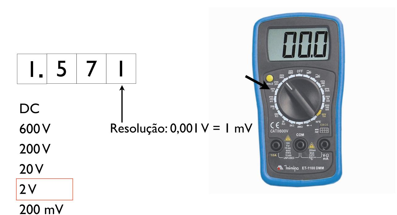
Mostrador com dígito "I" à esquerda: valor acima do máximo da escala
