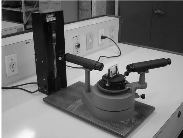
Figura 2.2: Espectroscópio preparado para medida.
